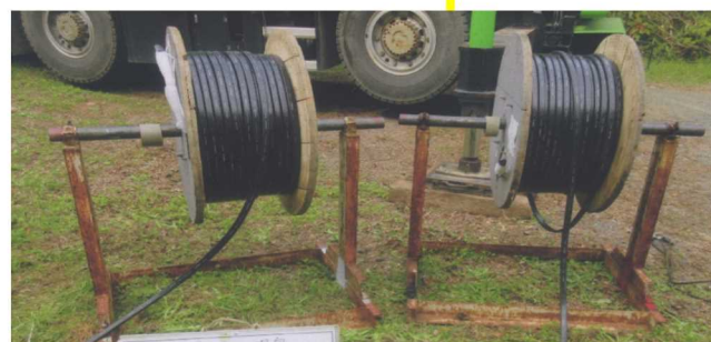
モーターから伸びる水中電線ケーブル。200mが2本。
