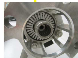
水中ポンプ。同じ形状の部品が21個つながっている。底の方にモーターが接続され、ポンプ本体に沿って電気ケーブルが地上へ伸びている。写真は分解した状態。
