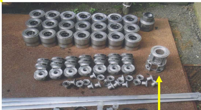
水中ポンプ。同じ形状の部品が21個つながっている。底の方にモーターが接続され、ポンプ本体に沿って電気ケーブルが地上へ伸びている。写真は分解した状態。
